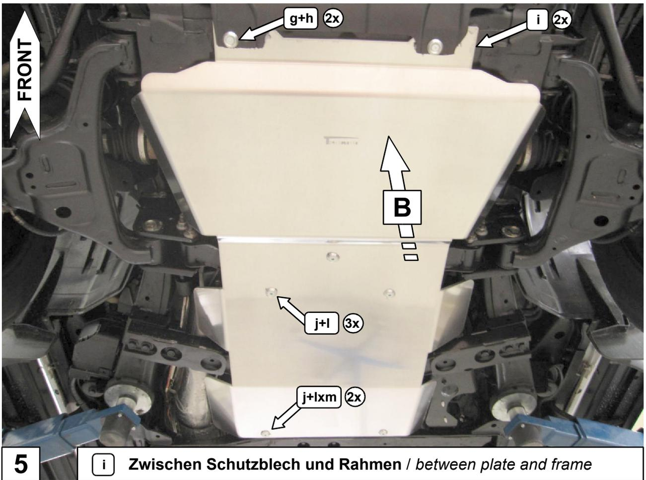
**5** **i** Zwischen Schutzblech und Rahmen / *between plate and frame*
